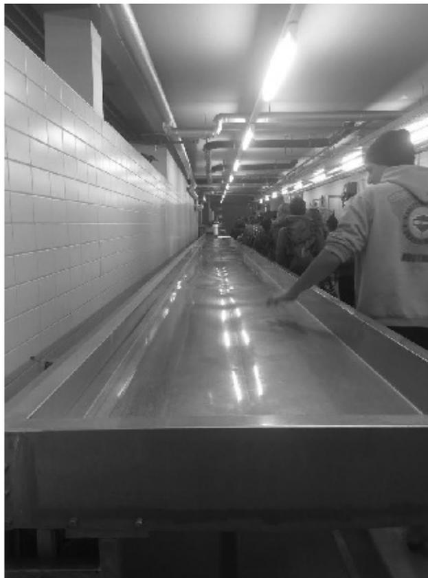
Reinigungs- und Prüfbecken für die Wasserschläue
